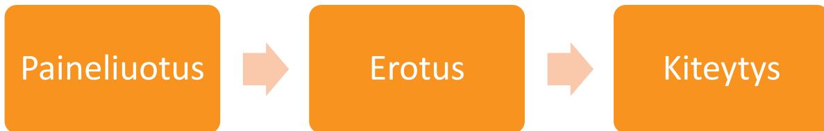
Kuva 7. Akkukemikaalitehtaan tuotantoprosessin päävaiheet
