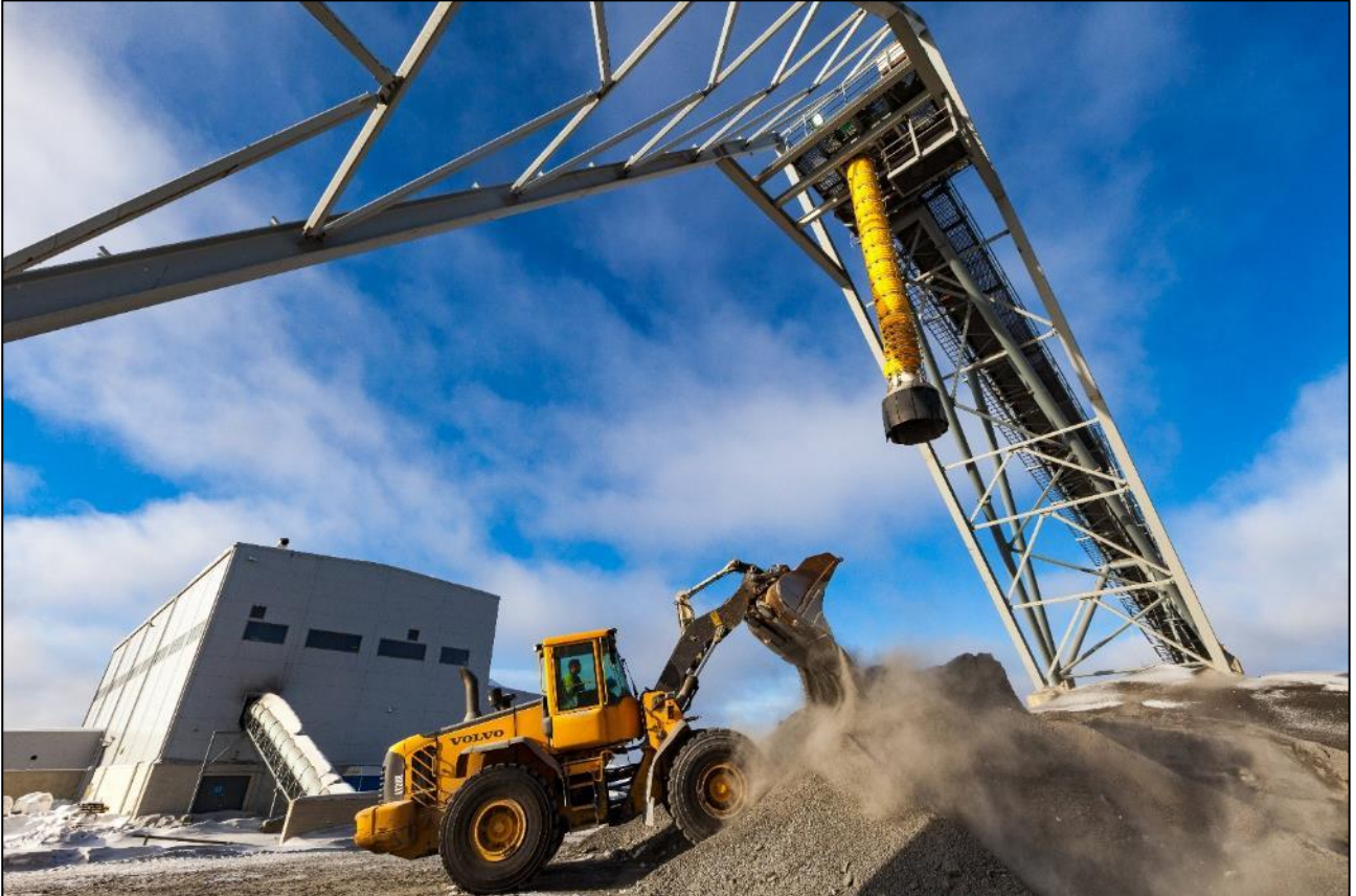
Kuva 16. Murskatun malmin pudotuskorkeutta säädetään ns. purkusukalla (Pampalon rikastamo, Endomines Oy)
