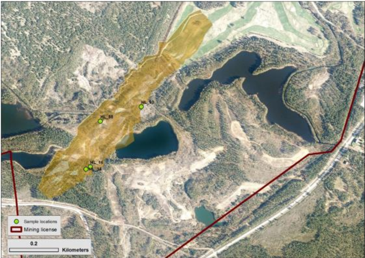
Kuva 24. Näytepisteiden sijainti. Rikastuskoe tehtiin kairasydännäytteistä HL-34, HL-88 ja HL-93 koostetulle kokoomanäytteelle. (lähde: GTK 2021)
